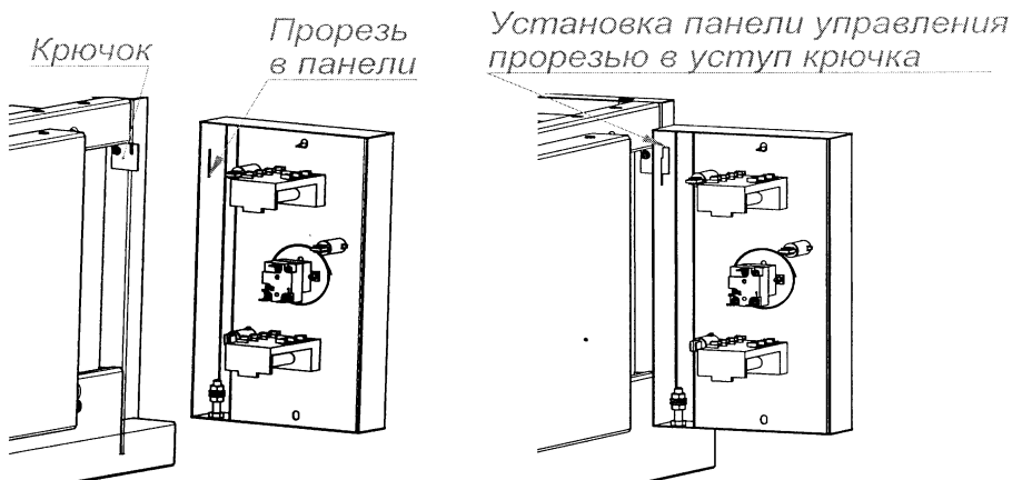
Рис.6 Схема установки панели управления при ТО
